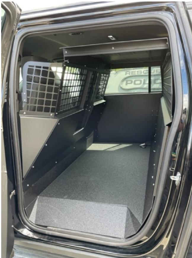
Figure 4 : Panneau de porte arrière et grillage
