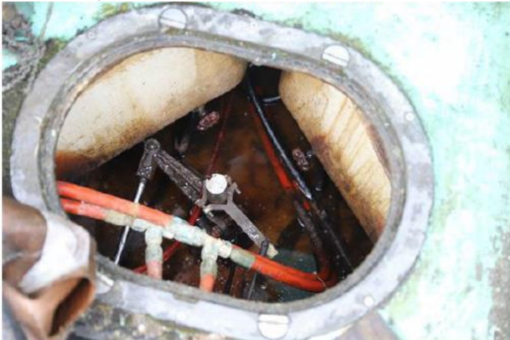
Image 4 : Montego Bay (Compartiment de l'appareil à gouverner, huile hydraulique qui flotte librement)
