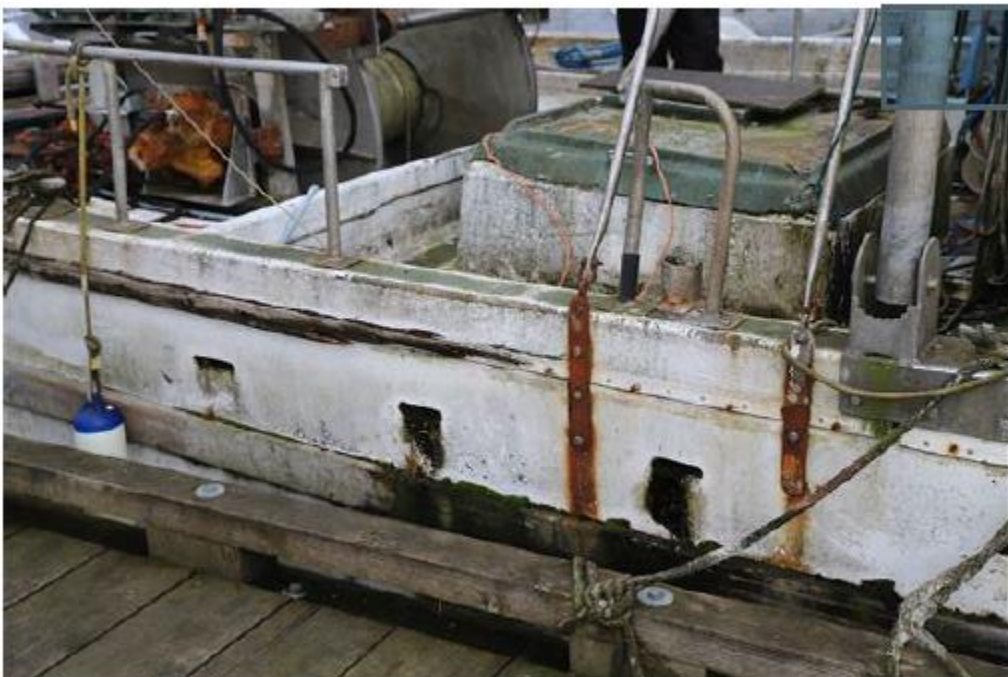
Image 4 : Tanner's Quest (Côté bâbord, détérioration de la coque)
